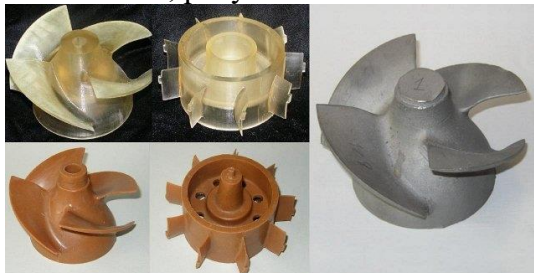
Рисунок 3 – SLA модель и готовая деталь
