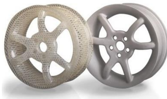
Рисунок 6 – Литейная модель, изготовленная по технологии QuickCast
